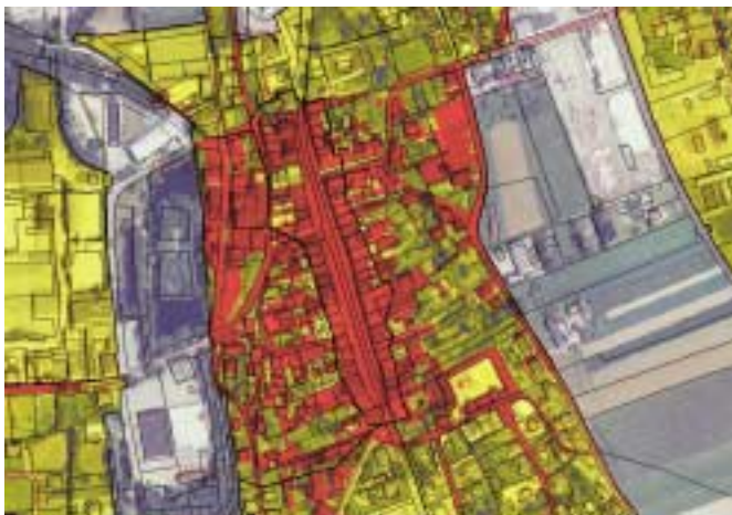
Ausschnitt des digitalen Orthophotos mit Grundgrenzen, Mischwassereinzugsgebiet (●) und an die Kanalisation angeschlossene befestigte Flächen (●). Foto: Machowetz & Partner Consulting
